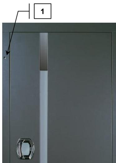
Рис. 9: Разъем замка под трехгранный ключ в полу автоматической двери
