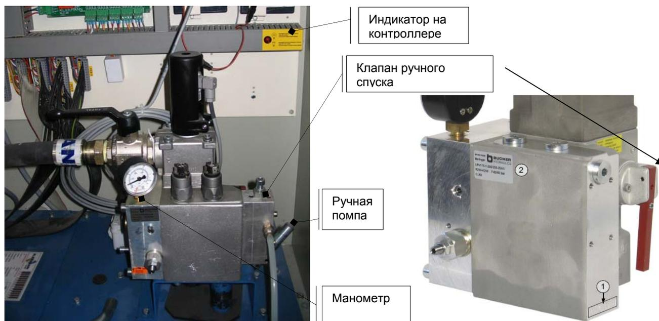
Рис. 1: Блок клапанов FlexyLift MR
