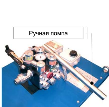
Рис. 1: расположение блока клапанов на гидробака
