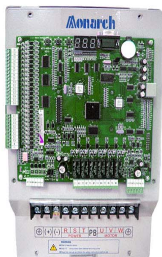
Рис. 1 NICE3000 комплексирование синхронного двигателя( в том числе SIZE-D 、 SIZE-E )
