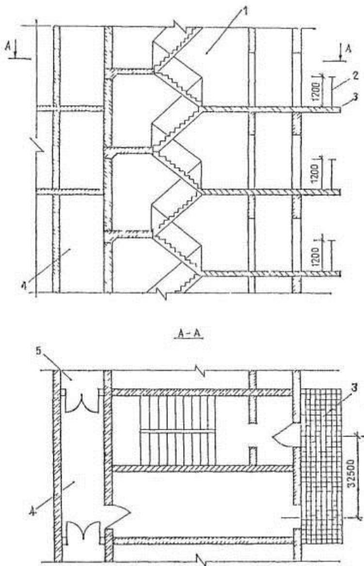
Рис. 24. Пример планировочного решения лестничной клетки с переходом через наружную воздушную зону по балконам
