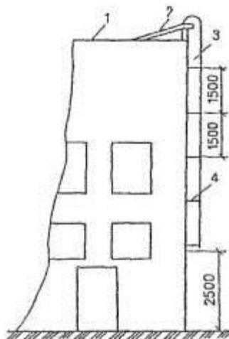
Рис. 22. Пример устройства наружной пожарной лестницы
