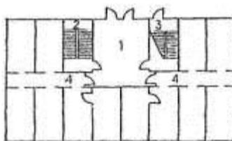
Рис. 21. Пример планировочного решения по устройству выходов из лестничных клеток через один вестибюль
