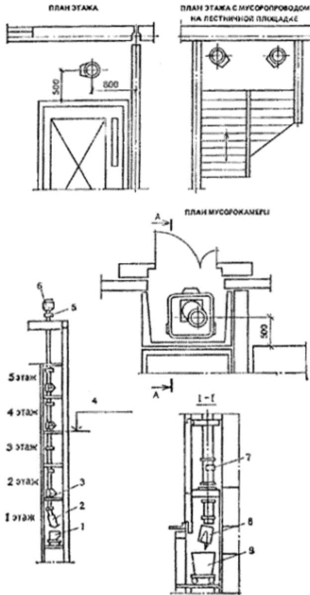
*Рис.13.Примерные схемы мусоропроводов*
