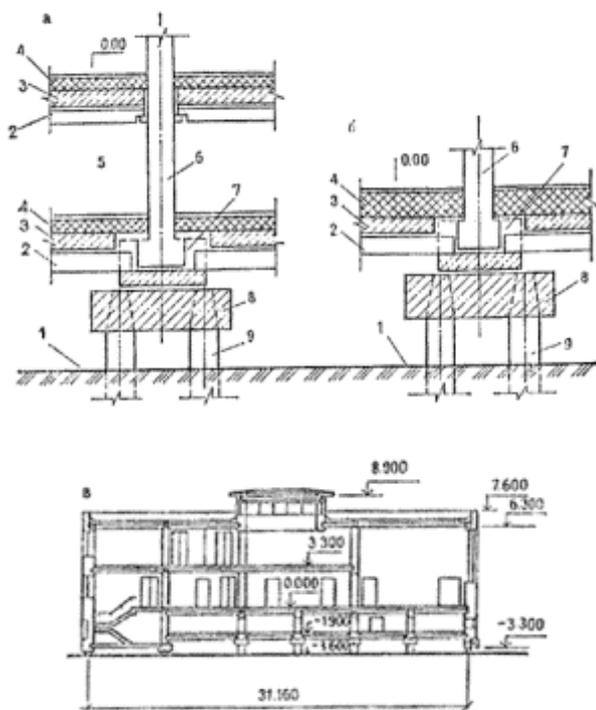
Рис. 1. Цокольно-фундаментная часть здания каркасной конструкции (1 принцип строительства)
