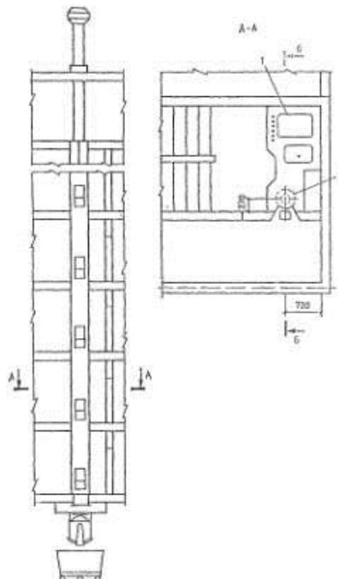
*Рис.16.Схема ствола мусоропровода, совмещенного с вентиляционным блоком*
