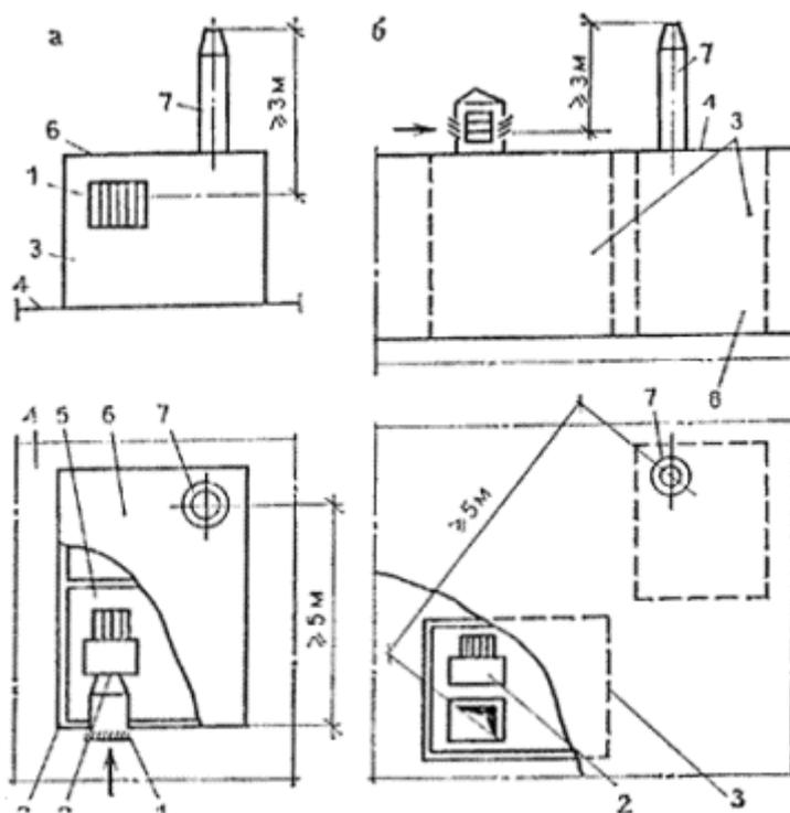
Рис. 28. Взаимнорасположение отверстий воздухозабора и выброса дыма системы противодымнойзащиты зданий
