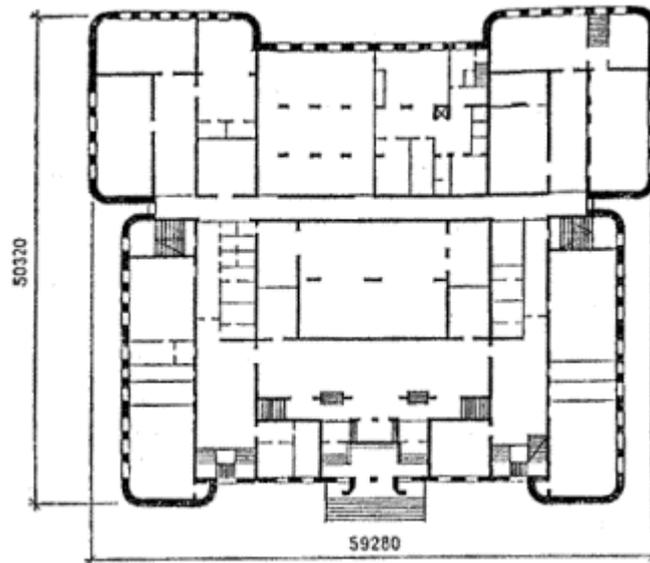
*Рис.2. Компактное решение здания (на примере общеобразовательной школы) с одним входом двойным тамбуром, обеспечивающим изменение направления движения*
