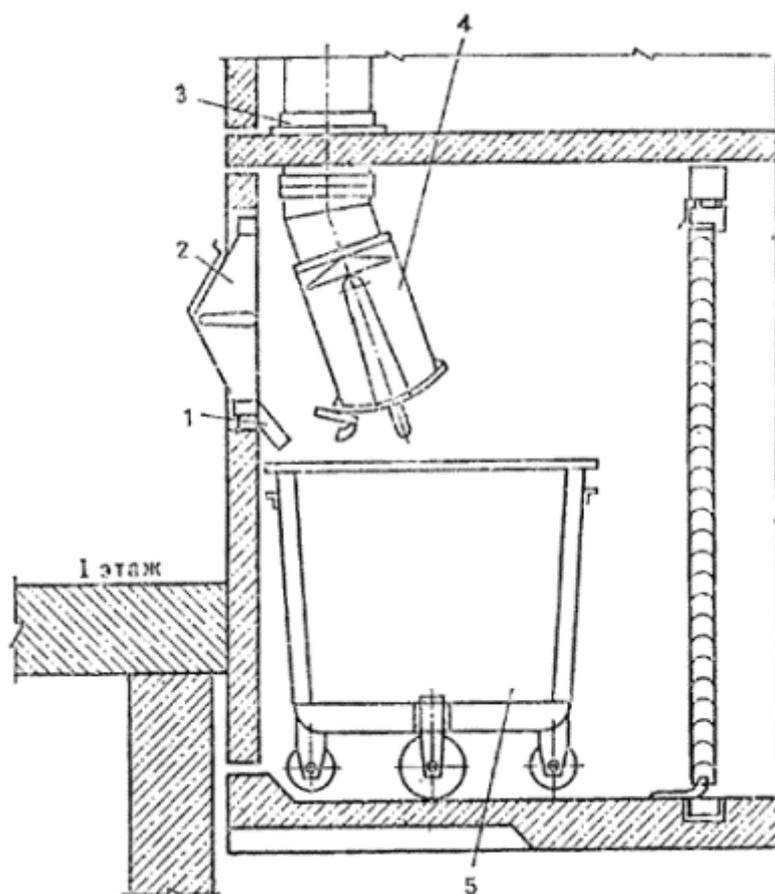
*Рис.14. Установка загрузочного клапана в стене мусоросборной камеры*
