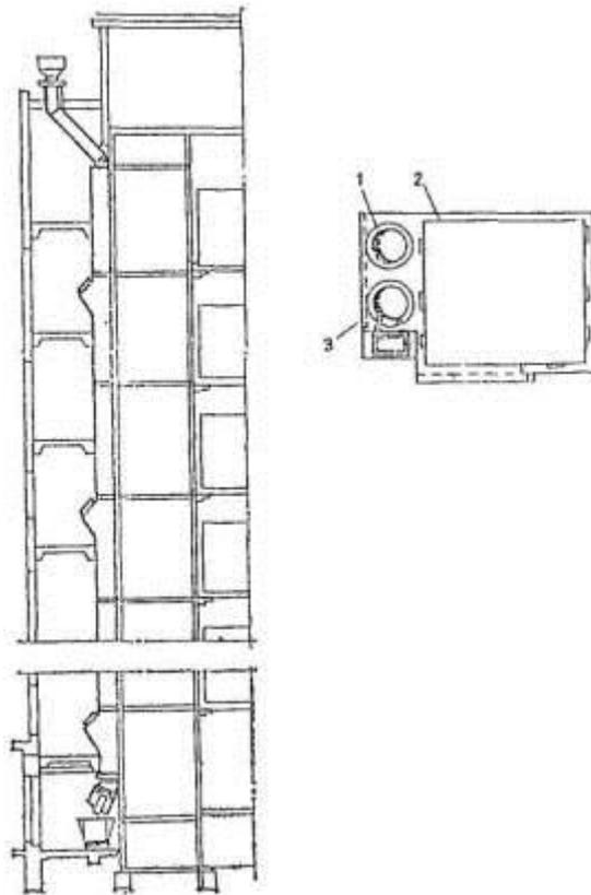
*Рис.15.Схема ствола мусоропровода, совмещенного с лифтовой шахтой*
