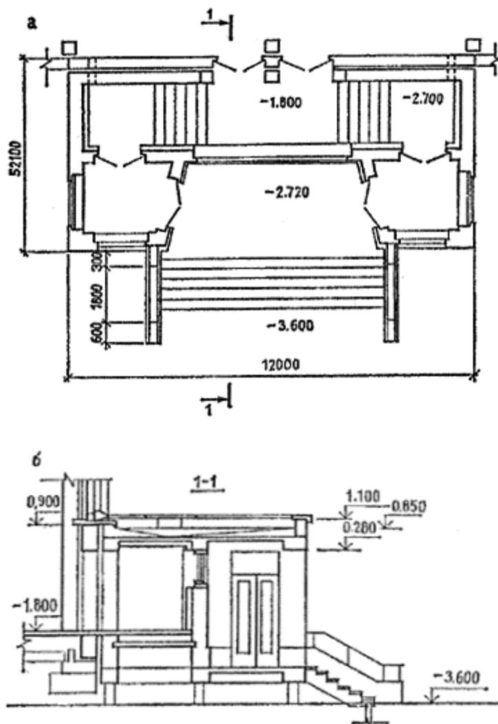
Рис. 4. Решение входа в здание (на примере общественного центра) с устройством двойного тамбура: а - план; б - разрез
