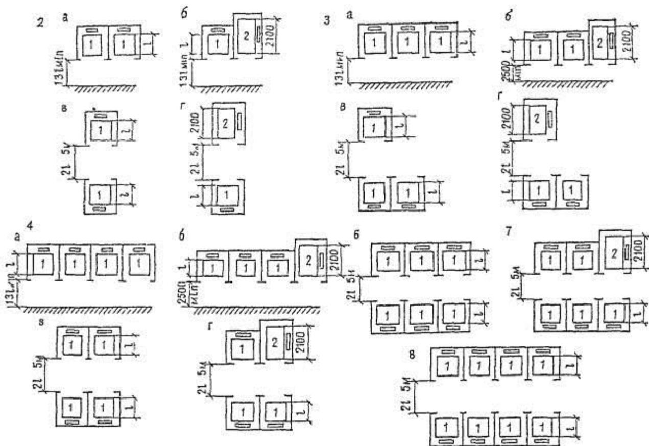
Рис. 8. Рекомендуемые сочетания расположение пассажирских лифтов, объединяемых типовой системой группового управления. Сочетания 2б, г; 3б, г; 4б, г; 6б только для лифтов со скоростями  $1u$  1,6 м/с
